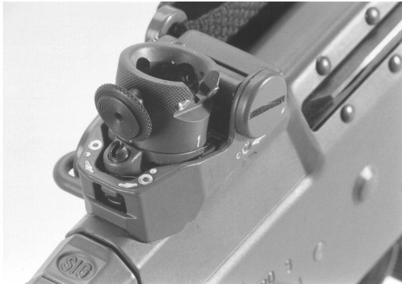
Bild 2: Irisblende zu Sturmgewehr 90 Modell Furter
