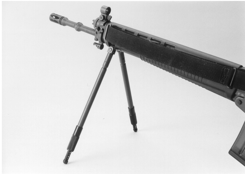
Bild 3: Verstellbare Zweibeinstütze zu Sturmgewehr 90 Modell SIG
